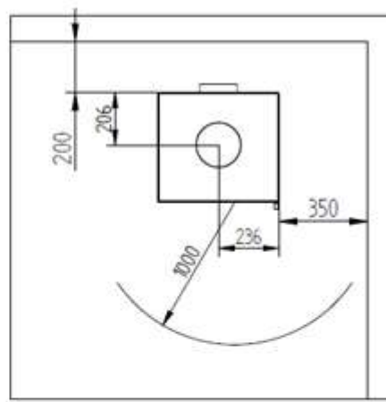
Afstand til brændbart UDEN isoleret røgrør
