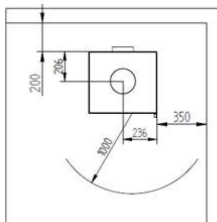
Abstand zu brennbarem Material OHNE isoliertem Rauchrohr
