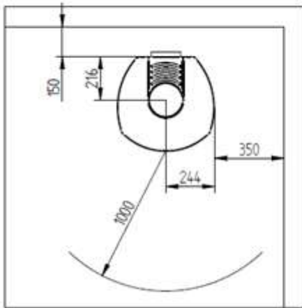
Afstand til brændbart MED isoleret røgrør
