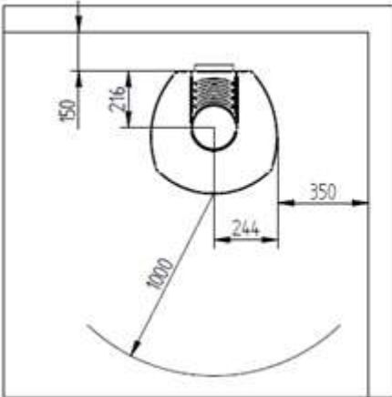
Avstand til brennbart MED isolerte røykrør
