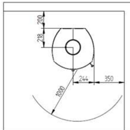
Afstand til brændbart UDEN isoleret røgrør
