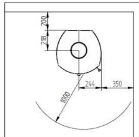
Avstand til brennbart UTEN isolerte røykrør
