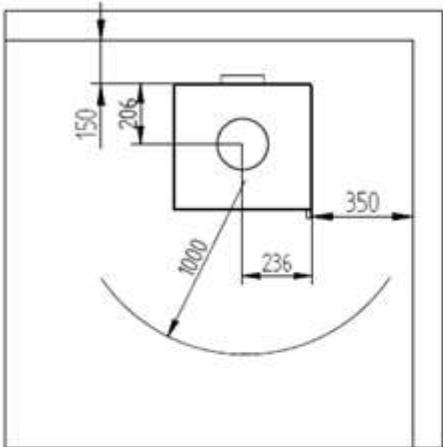
Distance des matériaux inflammables AVEC conduit de fumée isolé
