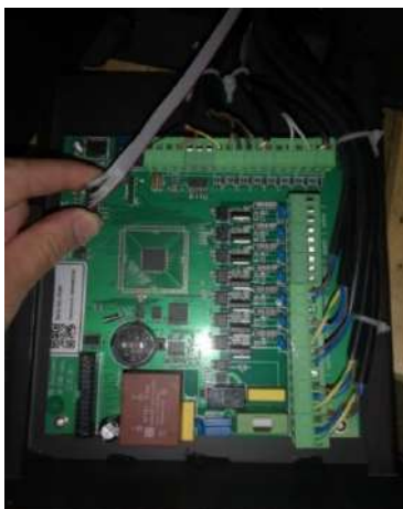
Bild 1: Trennen Sie das Displaykabel
