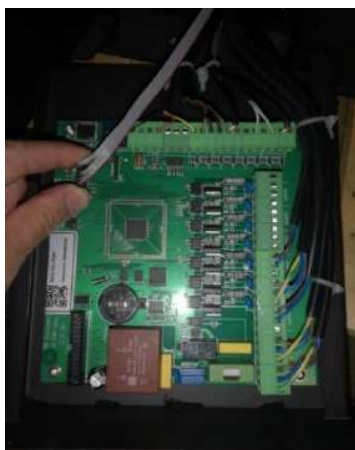
Photo 1: Débrancher le panneau de contrôle
