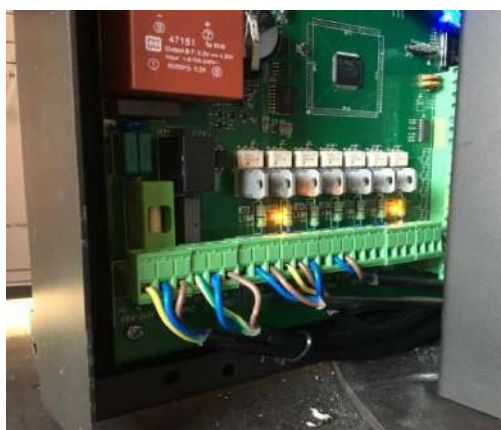
Billede 2: Styringsprint på Aduro Hybrid
