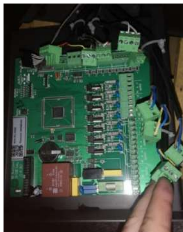
Bild 2: Trennen Sie die grünen Steckklemmen
