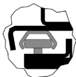
Fig. 62: C-formet skinne og føreruller
